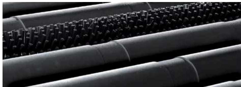
Spazzole con diverse caratteristiche per le esigenze di lavaggio più complesse (laminazione, bassi emissivi, spruzzatura ceramica e UV, solare, etc). La velocità di rotazione può essere gestita da inverter.
