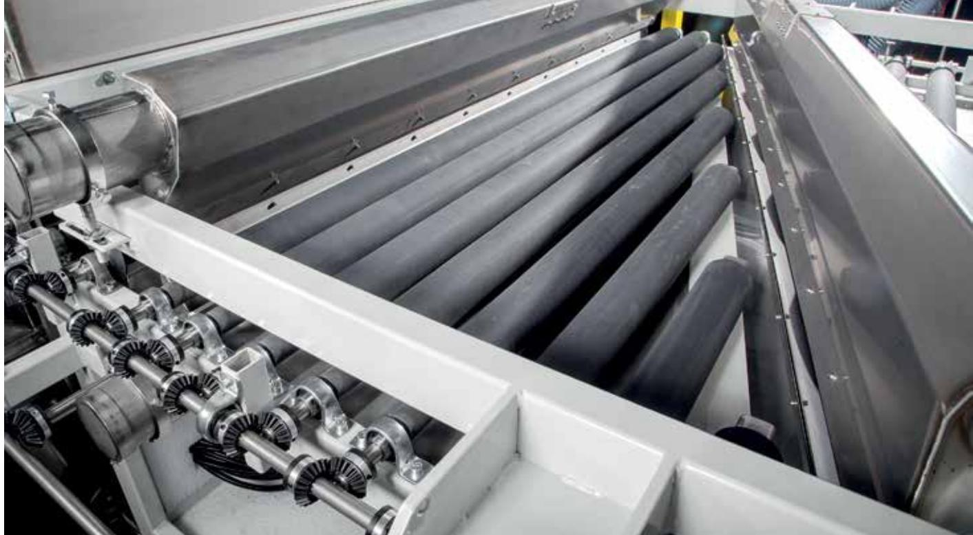
Zona di lavaggio completamente in acciaio inox. Soffianti di asciugatura e lamiera di raccolta acqua in acciaio inox.
