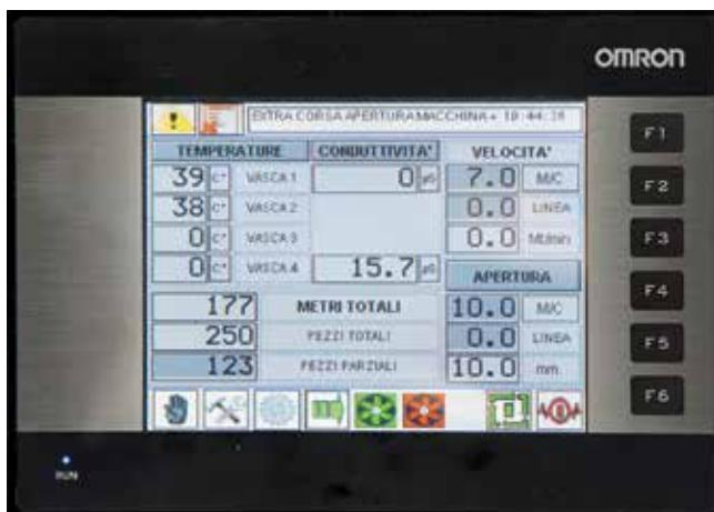
Potente unità di controllo con touch screen per gestione funzionalità macchina, diagnostica guasti, manutenzione programmata, controllo qualità acqua e gestione risparmio energetico, quando presente (Tornado HP e IC).
