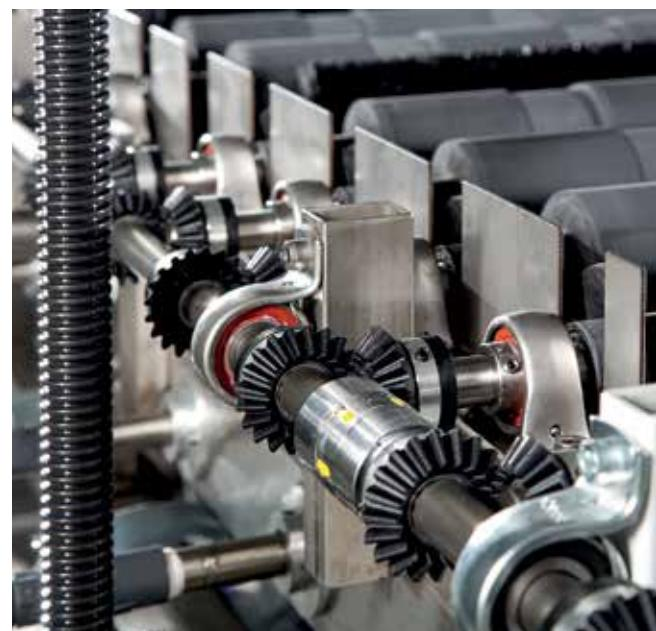
Trasmissione mediante coppie coniche in PA6 rinforzato, azionate da albero in acciaio inox, esenti da manutenzione.
