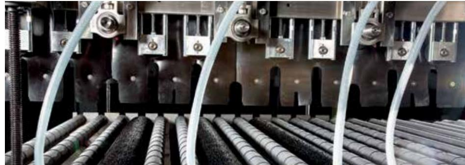
Rulli gommati fino alle estremità con gomma antimacchia, scanalati, vulcanizzati e rettificati per trasporto ottimale. Mozzi in acciaio inox.
